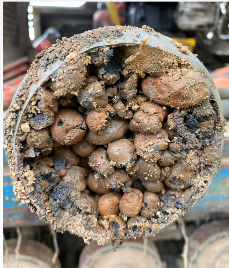
Ett prov på Leca Lättklinker taget från den del av vägbanken som ligger under vatten vid Varska, Estland.
