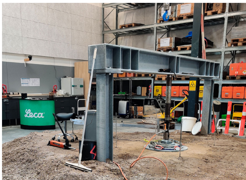
Mätutrustning installeras för att hitta Leca Lättklinker E-modulen.
