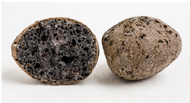
Leca lättklinker i genomskärning. Det starka, keramiska skalet och de inre hålligheterna syns tydligt på nära håll.
